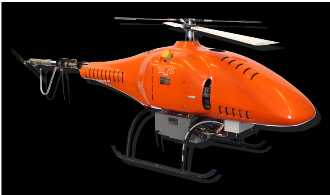
Фото 1. Внешний вид системы дистанционного экологического мониторинга на базе малогабаритного беспилотного летательного аппарата вертолётного типа «РДР-2015 Горный»
