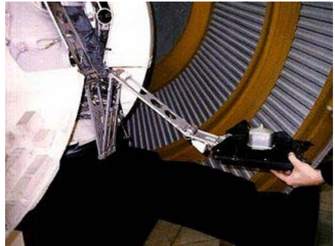
Фото 4. Прибор ПрОП-М с помощью рычажного механизма автоматически перемещается с посадочного блока на поверхность Марса для проведения исследований. (Представлен момент демонстрации работы механизма)
