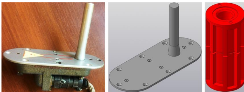
Радиоизотопный индикатор обледенения РИО-3 (слева), 3D-модели индикатора РИО-3 и свинцового чехла для его чувствительного элемента
