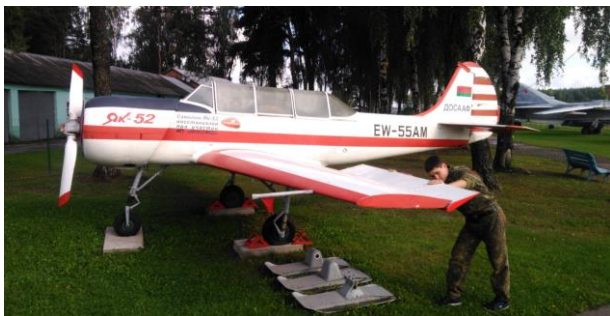
Курсант БГАА производит монтаж элерона на левое полукрыло учебно- тренировочного спортивного самолёта Як-52 – экспоната музейного сектора Минского аэроклуба ДОСААФ
