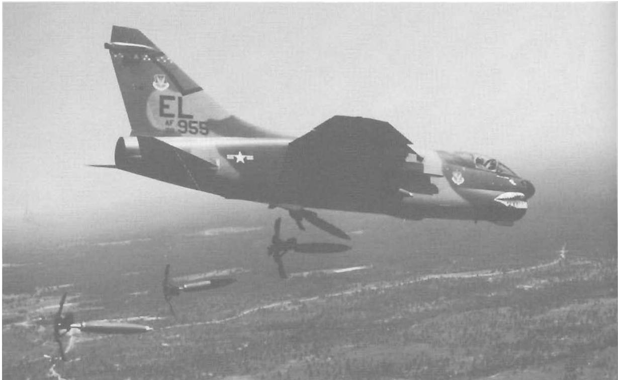
А-7 «Корсар» II. Применение бомбы «змеиный глаз» с зонтовидным стабилизатором
