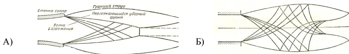
Рис. 1. Картина течения газа в сверхзвуковой струе
