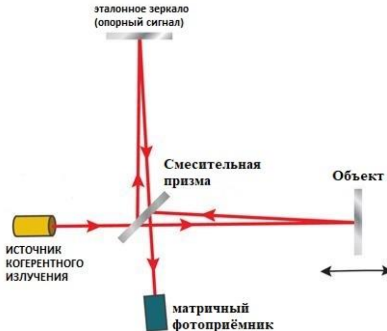
Рисунок 4. Упрощённая схема интерферометра
