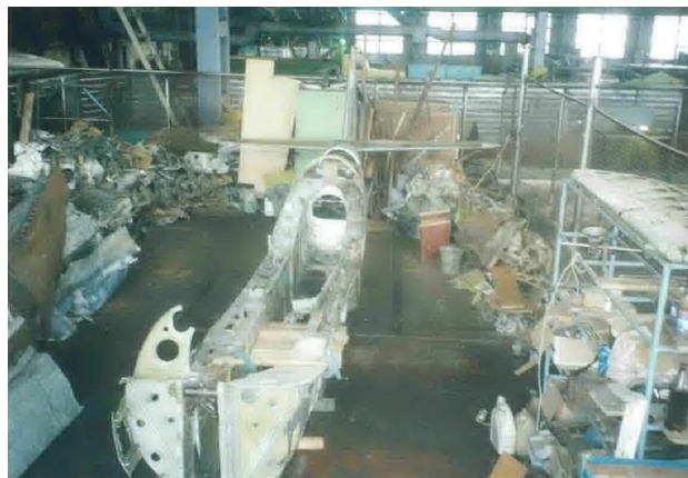
В Иваново ведутся работы по восстановлению самолёта Р-39 из исторического материала
