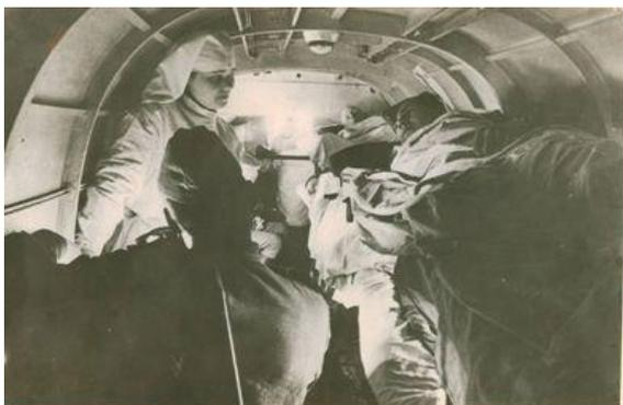
*Размещение раненых в кабине самолёта ШЕ-2. Альбом «Санитарная авиация в СССР и за рубежом». СССР, 1948 г. КП ОФ-24785/82*
